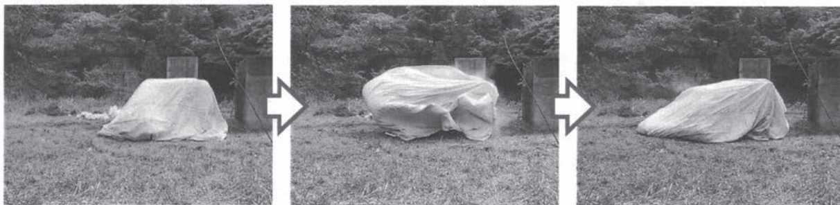
写真-27、28、29 破碎（点火）の瞬間における防護材の動き
