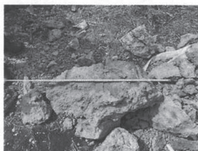
写真-30, 31 防護材取り外し後の破碎片（ガラ）の状況
